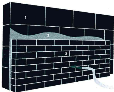
1. Dragende muur | 2. Ingeblazen isolatie | 3. Gevelsteen / gevelbekleding
